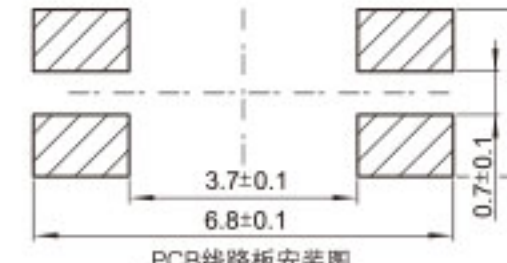
PCB线路板安装图
