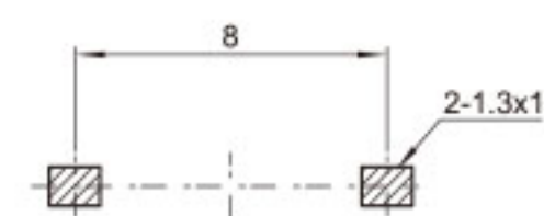
PCB线路板安装图
