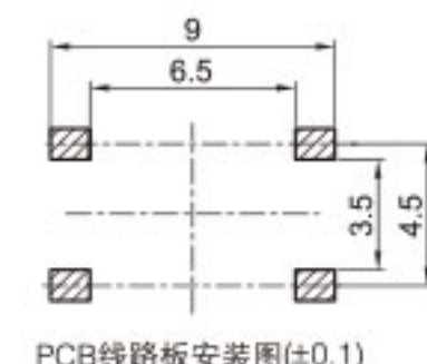
PCB线路板安装图(±0.1)
