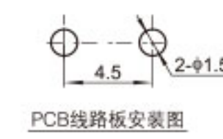
PCB线路板安装图
