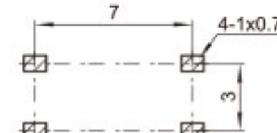
PCB线路板安装图
